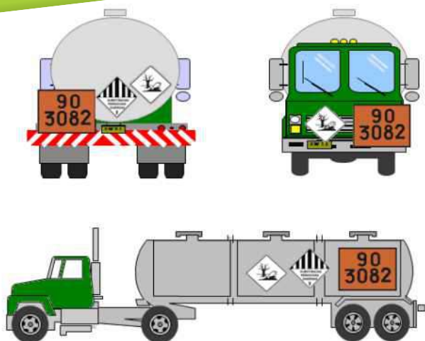
Figura E7- Veículo de transporte carregado com substâncias que apresentam risco para o meio ambiente (ONU 3077 e ONU 3082)
